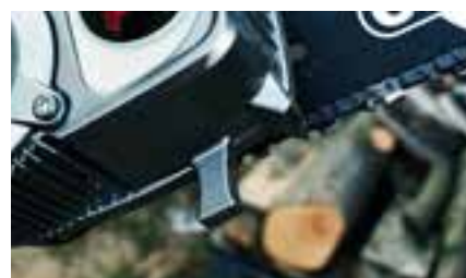
Krok til å dra greiner ut fra treet, uten å måtte avbryte arbeidet.
