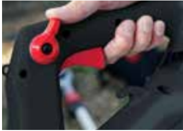
Cruisekontroll for komfortabelt, langvarig arbeid uten konstant å måtte holde gasskontrollen inne.
