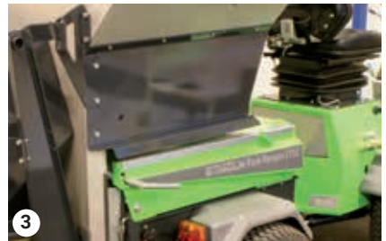
3 Senke salt- og sandsprederen
