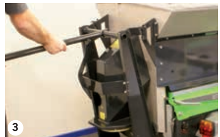
Senk salt- og sandsprederen
