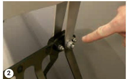
2 Bolter til omrørersystemet
