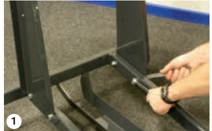
To bolter på valsestativet
